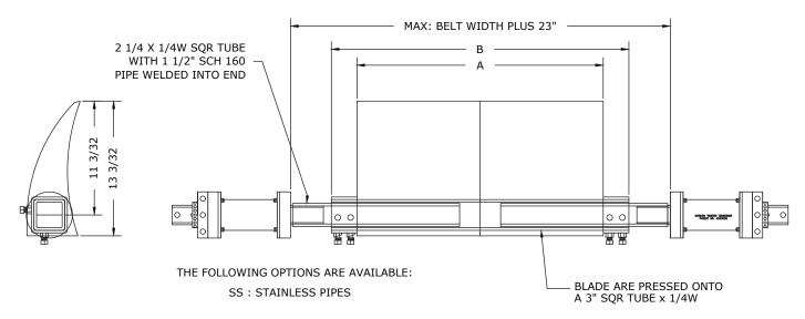
NOTE: IF LONGER SPAN IS REQUIRED, A LONGER MAINFRAME WILL BE REQUIRED. (CONSULT FACTORY FOR DETAILS)
