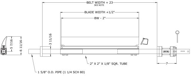
NOTE: IF LONGER SPAN IS REQUIRED, A LONGER MAINFRAME WILL BE REQUIRED (CONSULT FACTORY FOR DETAILS)
