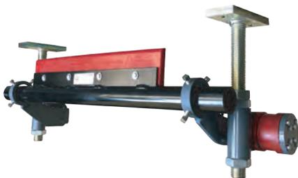
El limpiador secundario RGS cuenta con un brazo bastidor pesado al que soportan husillos de 1 pulgada y media. El tensor Twister interno posibilita que la hoja de carburo de tungsteno revestida de uretano mantenga una presión constante. Esta potente combinación acaba sin problemas con los residuos que hayan esquivado al limpiador primario.
