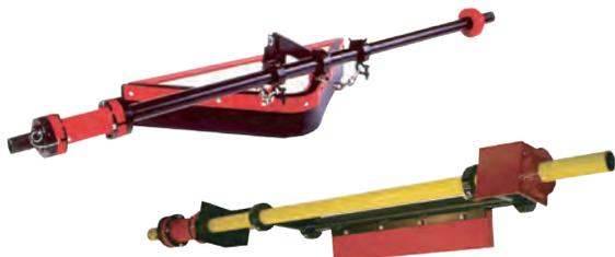
El sistema V-Plow descarga material a ambos lados de la cinta mientras que el sistema tipo arado en ángulo (Angle Plow) solo lo descarga a uno de los lados. Estas soluciones eliminan las acumulaciones irregulares en la polea de cola que provocan la desalineación de la cinta.
