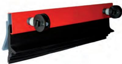
Por medio de su mecanismo de leva, el sistema de sujeción Ca-A-Lot hace que el cambio de la goma del tablero se haga con mucha rapidez. Las cabezas de sujeción giratorias de 360 grados ofrecen un ajuste personalizado en un lugar que en otros casos no sería utilizado. Gracias a una simple y sencilla instalación por soldadura, el sistema Cam-A-Lot se convierte en una solución sin complicaciones para el sellado de la zona de carga.
