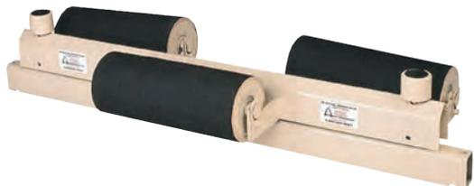
El rodillo de tensión de entrenamiento Tri-Return utiliza una configuración patentada convexa de tres rodillos de tensión auto-ajustables sobre un pivote central que centra de forma automática su cinta de transporte. El rodillo central se encuentra en posición horizontal, mientras que los otros dos han sido colocados en ángulo descendente. Esta configuración permite que el sistema de entrenamiento se ajuste por completo al perfil de la cinta de transporte de retorno.
