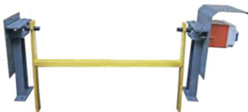
El CTS 700 RBL utiliza dos brazos abatidos para detectar la desalineación de la cinta de retorno. Si la cinta se desvía a la derecha o a la izquierda, tanto que pueda dañar la cinta o la estructura del sistema de transporte, entra en contacto con uno de los brazos abatibles. Estos brazos están conectados a un interruptor eléctrico a través de un mecanismo de conexión de policarbonato reforzado con fibra de vidrio.
