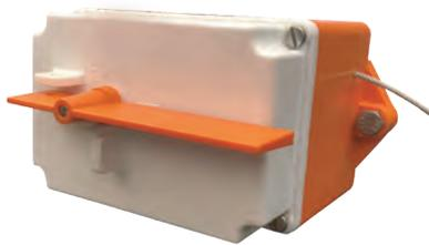
El interruptor CTS 100 utiliza un interruptor giratorio eléctrico, para que el personal pueda activarlo de forma manual. Este interruptor es un interruptor giratorio autodeslizante (no un microinterruptor), y consta de dos contactos abiertos y dos cerrados. Una vez que se haya activado el interruptor, la bandera de color naranja se encuentra en la posición "arriba" para avisar al personal de mantenimiento. Deberá reiniciarse de forma manual para volver a arrancar la cinta.
