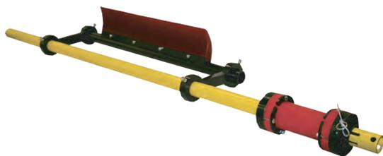
Los limpiadores secundarios ARCH Saber® (GSS), incorporan la forma consolidada del Saber® a un limpiador secundario tipo voladizo. El tensor patentado Twister aplica una presión óptima de limpieza para eliminar los residuos a la vez que permite a los empalmes mecánicos pasar sin problemas, evitando que tanto la hoja como la cinta o los empalmes sufran daños.
