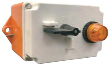
El interruptor CTS 200L utiliza un interruptor giratorio eléctrico, para que el personal pueda activarlo de forma manual. Este interruptor es un interruptor giratorio autodeslizante (no un microinterruptor), y consta de dos contactos abiertos y dos cerrados. Una vez activado, la bandera de color azul se encuentra en la posición "arriba" y se enciende la luz (para que sea visible para el personal de mantenimiento). Deberá reiniciarse de forma manual para volver a arrancar la cinta.
