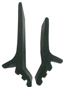
El sistema de sellado Talon, usa un diseño único con múltiples barreras para retener el polvo y las partículas en la cinta. Este sistema de sellado utiliza el peso de la carga para aumentar o disminuir la presión de sellado a la cinta; es decir, las cargas pesadas crean más presión y las cargas más ligeras, menos presión.
