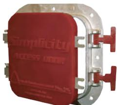
Las puertas de acceso Simplicity cuentan con una tapa de poliuretano que proporciona un sellado natural y hermético. Las aberturas pueden ser de 8" y de 12". Estas puertas resistentes a la corrosión se atornillan o sueldan con facilidad a las estructuras existentes por medio de una placa opcional de adaptación. Dichas puertas nos permiten acceder con facilidad a la cinta para proceder a su inspección sin que se produzcan fugas.
