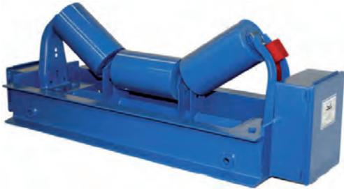
La balanza Archweigh SC ofrece una precisión de pesado de 1%-2% y se ajusta de forma automática al movimiento de la cinta, gracias al sistema de células de carga de extremo a extremo patentado por Arch. Este singular diseño compensa las fuerzas externas ejercidas sobre la cinta cuando las células de carga fuerzan reacciones conversas; una empuja hacia arriba mientras la otra empuja hacia abajo. (No es necesario volver a calibrar constantemente)
