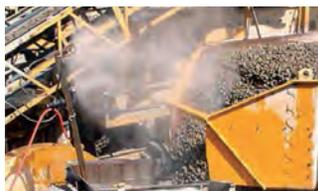
Los cabezales de atomización en racimo cuentan con boquillas estándar del nº3. La cantidad de boquillas depende del cabezal de atomización requerido. Es posible añadir un filtro y una válvula esférica a la barra de atomización o al cabezal. Las bombas cuentan con un filtro, una válvula esférica, un regulador de presión, así como con un indicador de presión. **Las opciones de voltaje para los motores son de 120/240 o de 230/460.**
