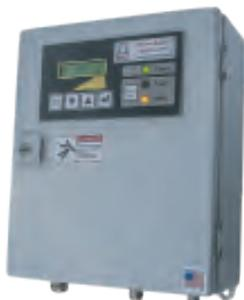
El EMT 100, cuenta con un nivel de sensibilidad del 10% y puede detectar tanto metales ferrosos como no ferrosos. Puede usarse en cintas que contengan grapas metálicas o empalmes de reparación gracias a nuestro detector opcional de grapas. La apertura puede ajustarse hasta un máximo de 23,5" para acomodar cotas de carga de hasta 19,5". Su diseño ligero y flexible permite desplazar la apertura del detector en planta. El EMT 100 está disponible para anchos de cinta de hasta 48".
